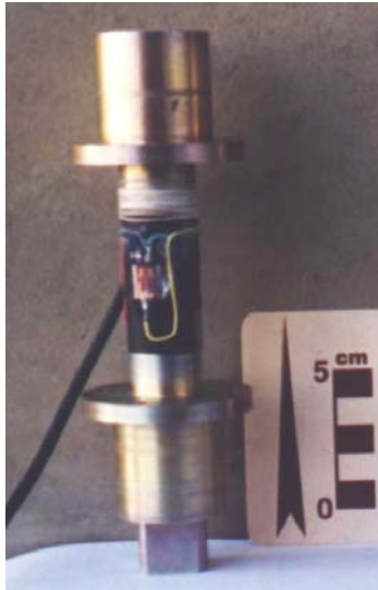
FIGURA 14 - Torquímetro elétrico com capacidade máxima de 20 kgf.m
