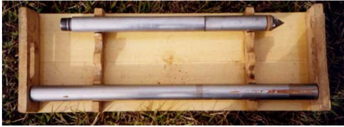
FIGURA 34 - Ponteira Cone-atrito elétrica, utilizada nos ensaios CPT
