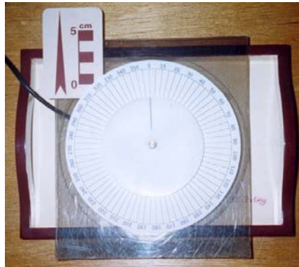
FIGURA 21 - Sistema de calibração do potenciômetro
