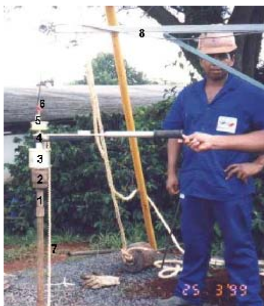
FIGURA 24 - Sistema do ensaio com torquímetro elétrico e medidor de ângulo
