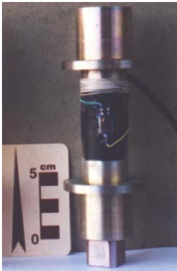
FIGURA 15 - Torquímetro elétrico com capacidade máxima de 50 kgf.m
