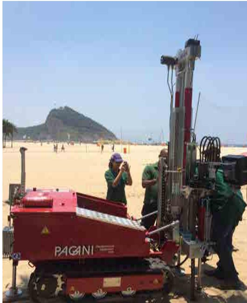
Fig. 2.25 - Equipamento da COPPE/UFRJ, fabricação Pagani, realizando ensaios na praia de Copacabana por ocasião da presente pesquisa.
