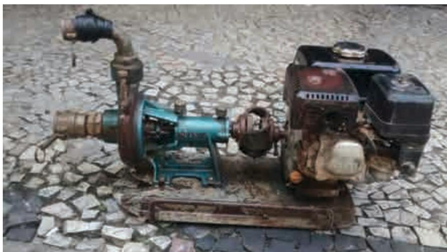
Fig. 2.5 - Detalhe da bomba de circulação de água utilizada durante a realização da sondagem.
