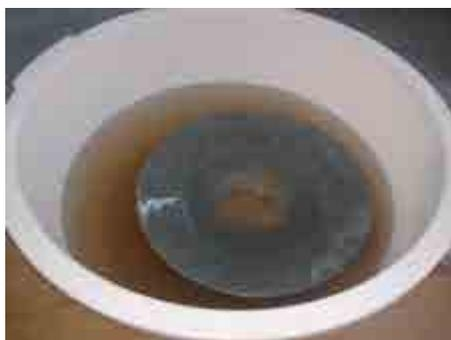
Figura 1 –Bateia utilizada para concentração de minerais pesados.
