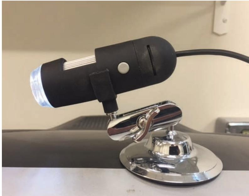
Fig. 4.21 - Microscópio digital utilizado para a obtenção das imagens ampliadas dos grãos de areia.
