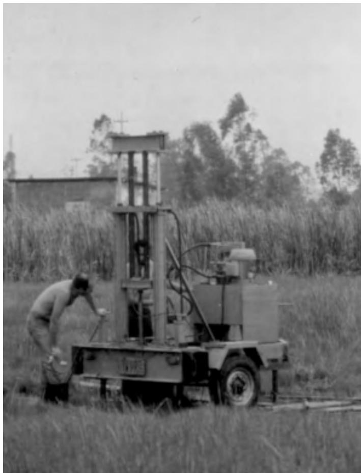
Fig. 2.24 – Equipamento de cravação produzido em 1985 pela COPPE/UFRJ (Danziger, 1990).
