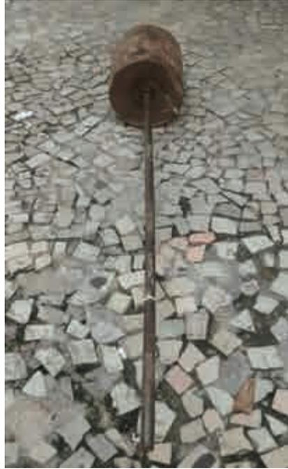
Fig. 2.2 – Martelo padronizado do ensaio SPT, na praia de Copacabana, por ocasião da presente pesquisa.
