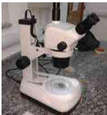
Figura 5 – Lupa estereoscópica onde é realizada a caracterização mineralógica..
