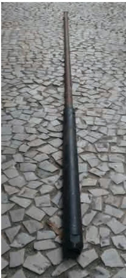
Fig. 2.1 – Amostrador padrão do ensaio SPT, na praia de Copacabana, por ocasião da presente pesquisa.
