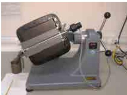
Figura 4 – Aparelho Frantz utilizado para separação eletromagnética.
