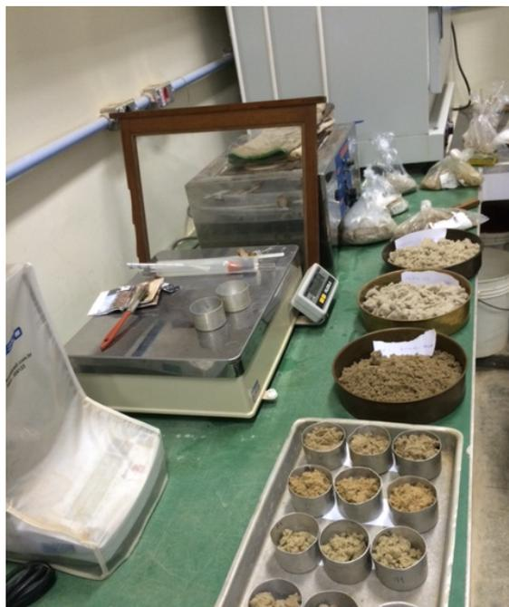
Fig. 4.15 – Amostras separadas após secagem em estufa, preparadas para pesagem do material seco – ensaio de determinação de umidade em execução.
