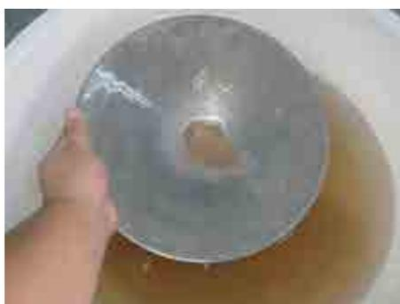
Figura 2 – Concentrado de minerais pesados retidos no fundo da bateia.
