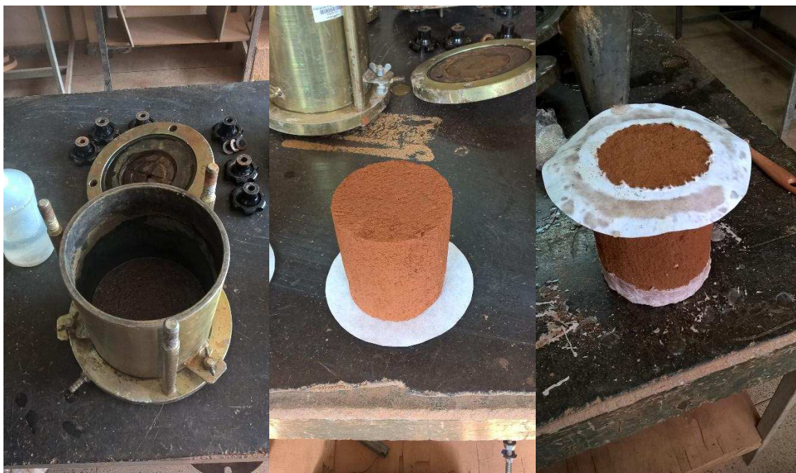
Figura 35: Preenchimento inicial da camada de areia e preparação do corpo de prova para ser inserido na célula. Após esta etapa é colocado no entorno do corpo de prova argila bentonítica (Material com característica de vedação por possuir um coeficiente de permeabilidade muito baixo, quase que impermeável) que tem como finalidade impedir o fluxo preferencial no contato entre a câmara e o corpo de prova, garantindo assim que o mesmo ocorra somente no corpo de prova. Após esta camada de bentonita, é colocada outra camada de parafina ao redor do corpo de prova e subsequente camada de areia, como visto na Figura 36.
