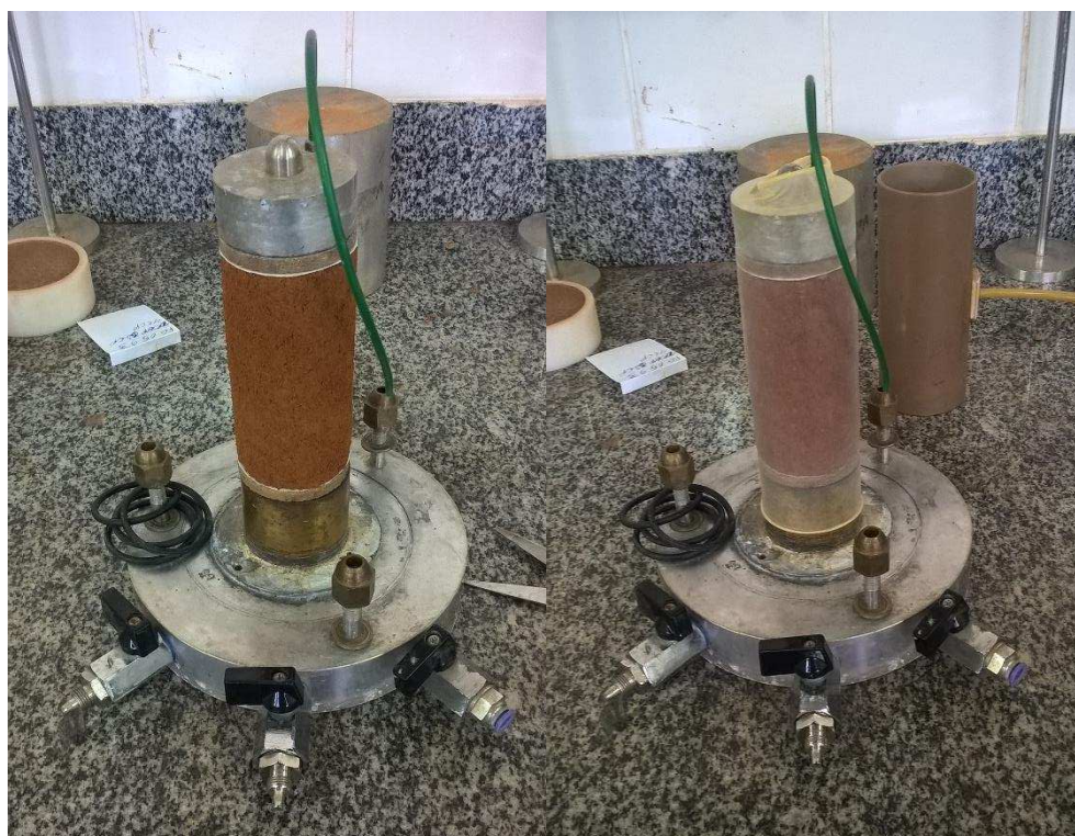
Figura 39: Instalação do corpo de prova na célula.
