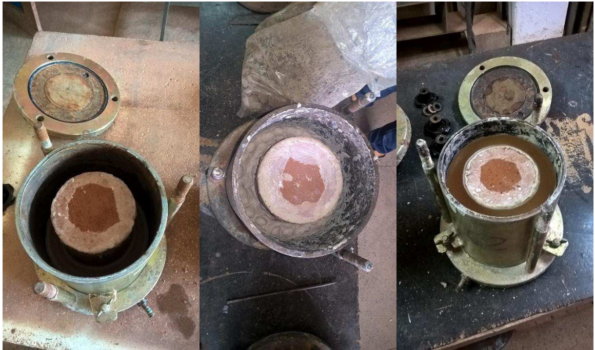
Figura 36: Preparação do ensaio com a colocação da parafina e da lama bentonítica.
