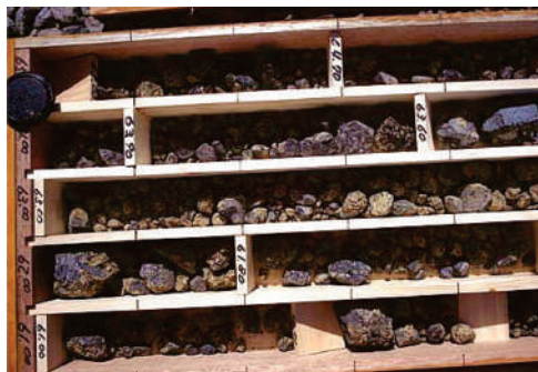
Figura 35 – Amostra de brecha vulcânica obtida por sondador sem experiência.
