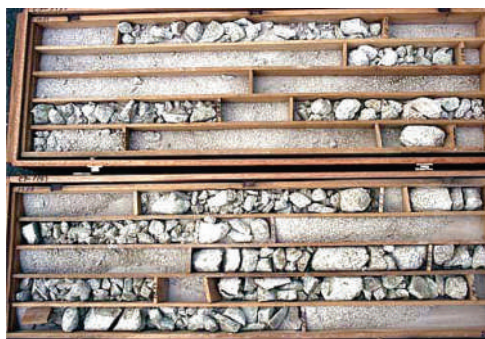
Figura 37 – Amostra de granito alterado obtido de barrilete duplo-livre diâmetro NX, segundo técnica dos anos 80.
