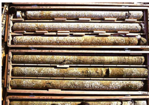
Figura 42 – Amostragem de granito alterado obtido por técnicas de alta qualidade com 86 mm de diâmetro e com injeção de bolhas ( air bubble ).
