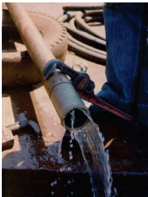
Figura 28 – Sondagem rotativa: barrilete duplo-livre de 86 mm, Série T (paredes finas).
