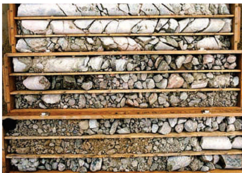
Figura 41 – Amostragem de granito alterado obtido com barrilete de 86 mm de diâmetro.
