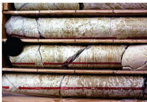
Figura 38 – Amostra de granito alterado obtido em barrilete triplo de 86 mm de diâmetro.
