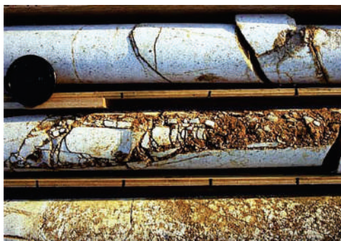
Figura 40 – Amostra de granito alterado obtido por técnicas de alta qualidade de amostragem com uso de barrilete duplo-livre e injeção de bolhas ( air bubble ).
