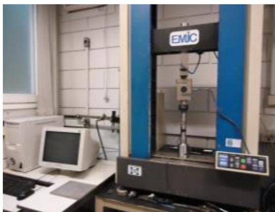
Figura 20 - Calibração da célula de carga.
