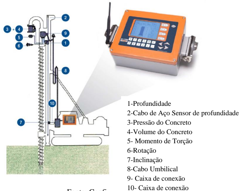
Figura 8 - Detalhe dos sensores e suas localizações na perfuratriz
