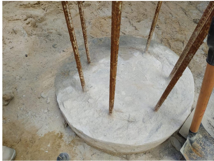
Figura 22 – Superfície da estaca preparada para o ensaio PIT
